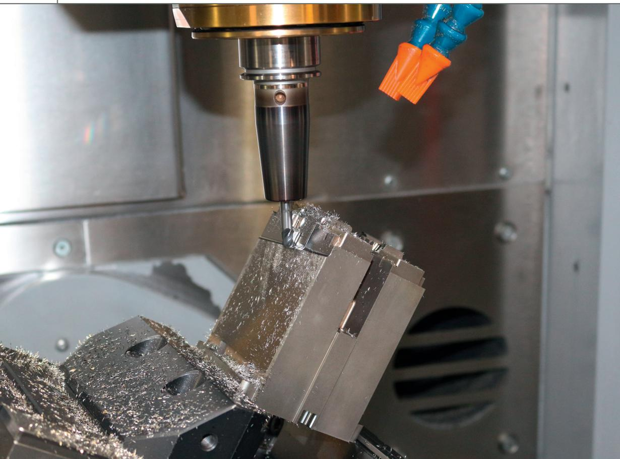
**Maßarbeit:** Einen vierschneidigen 0,6-mm-Kugelfräser von Iscar nutzt Oelfke Formenbau, um wie hier die Konturen in ein Spritzgusswerkzeug einzubringen, mit dem Gehäuse für Elektrobauteile in der Automotive-Branche gefertigt werden © Iscar
